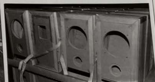
Des coffrets assemblés et collés, on remarquera l'inclinaison de la ligne acoustique triangulaire
