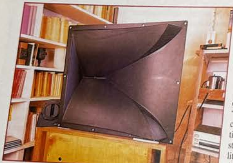
Vue du pavillon à image stéréo constante JBL 2346-1, on notera l'orientation du tweeter JBL 2405.
