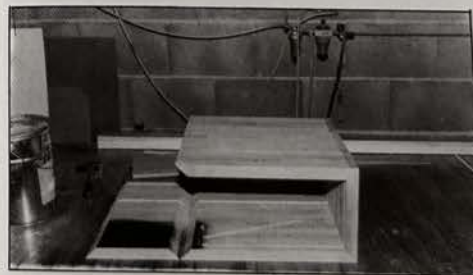
Il suffit de replier le montage à plat pour réaliser le coffret
